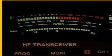
Un S-METER se calibra conectando un generador de señal al terminal de la antena con una potencia de salida (ver tabla) y ajustando el calibrador del S-meter para una lectura S-9.
